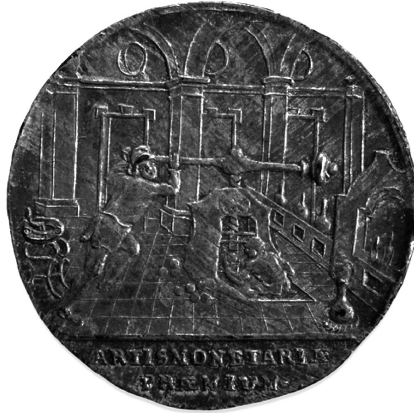
図 3-7 ねじ機構を用いたスクリープレスによる硬貨製造 (18世紀)
