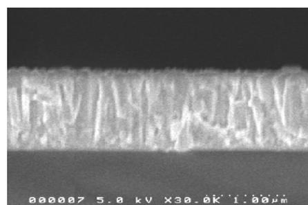
図10 堆積薄膜の断面 SEM 画像
