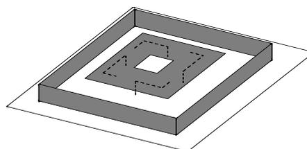
図7 非励振ループ素子を設置したパッチアンテナ
