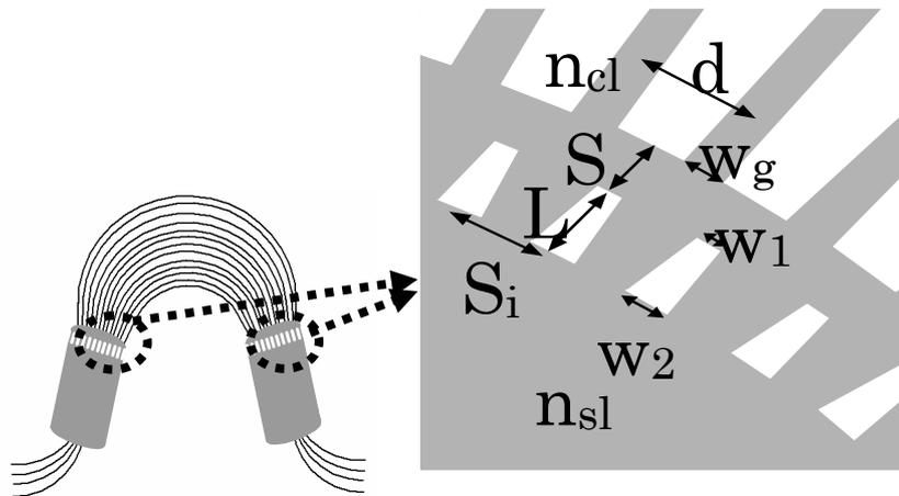
図4 AWGの概観図とアイランド素子の配置図
