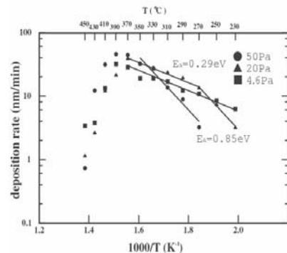
図 13 堆積速度の堆積温度依存
