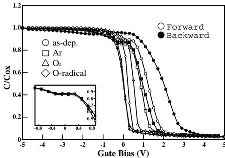
図 11 熱処理雰囲気別 C-V 特性
