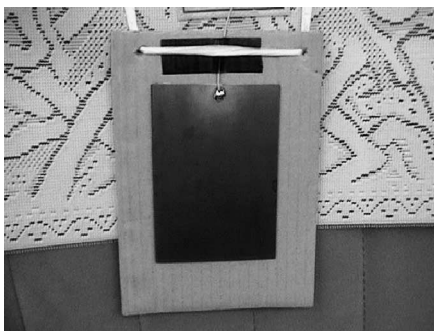
図 4 シート背もたれ上の電極 Fig. 4 Electrode on the seatback.
