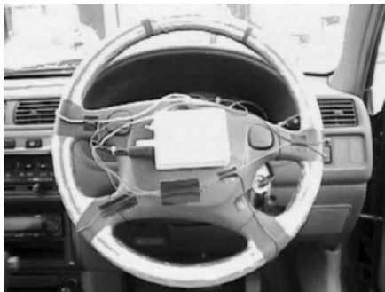
図 3 ステアリングホイール上の送信機と電極 Fig. 3 Transmitter and electrodes on the steering wheel.
