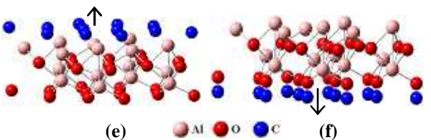
Fig.4 アルミナクラスターの O 界面の O 原子上に、(e)Al 界面と、(f)O 界面に C 原子 12 個を配置した図
