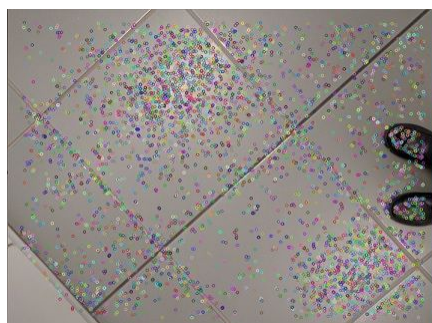
図2 B-ORBによる特徴点抽出
