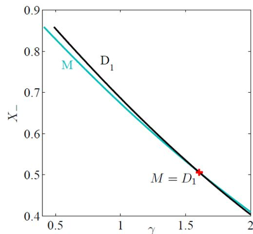
図2：2目的パラメータ探索。 $X_c$ は制御しきい値、 $\gamma$ は制御クロックに対応するパラメータ。カーブ  $D_1$  は安定境界、カーブ  $M$  は最大電力点に対応。その交点(赤)が目標値。
